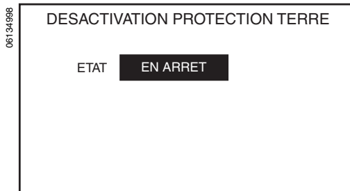
Figure 51 : Écran « Désactivation protection terre » désactivée
