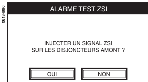
Figure 42 : Écran d'initialisation du test ZSI
