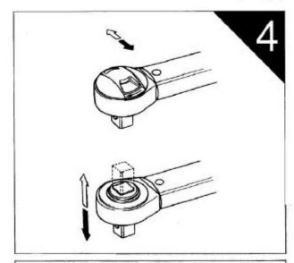
Set ratchet direction • Régler la direction de serrage • Wahl der Arbeitsrichtung • Fissare direzione cricchetto • Seleccionar
