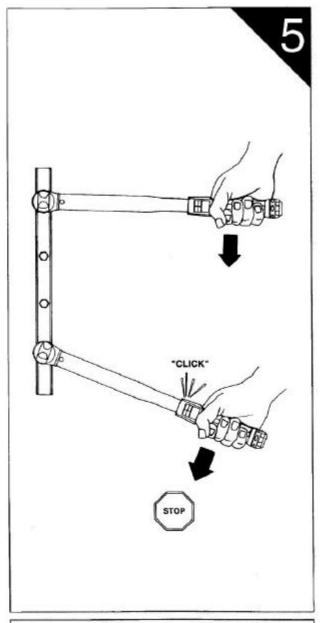
Apply Torque • Appliquer le couple • Drehmoment Anwendung Applicare la coppia • Aplicar el par de apriete
